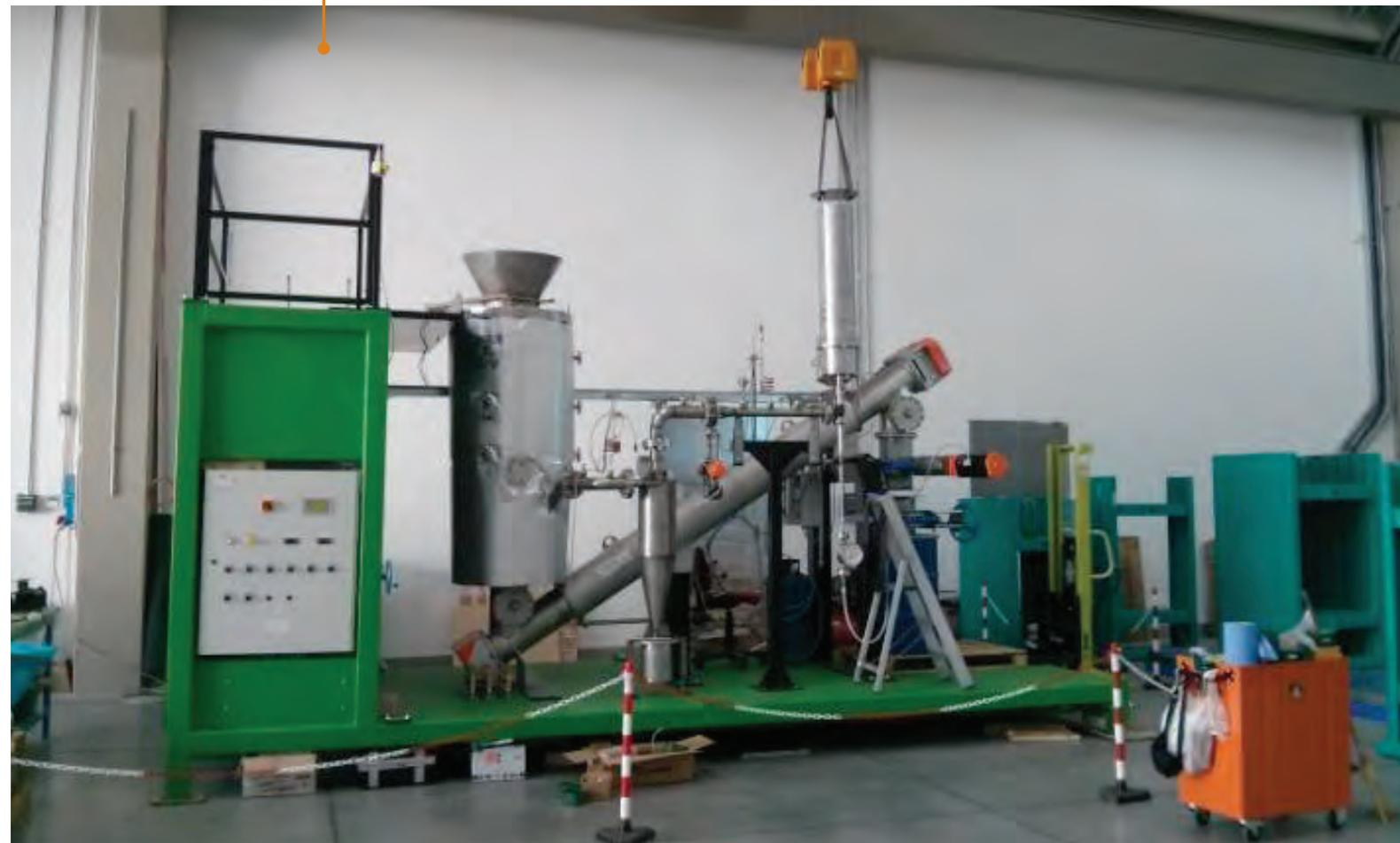
*foto: Impianto pilota di torrefazione in costruzione*
