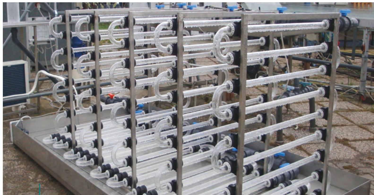
fig 4: Fotobioreattore tubolare da esterno.
