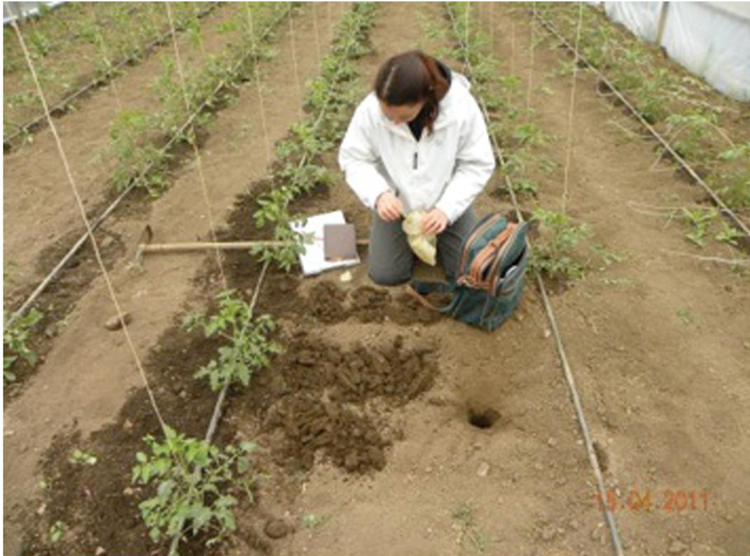
Campionamento del suolo osservazione della sequenza dei diversi carotaggi lungo il profilo di suolo (foto di B. Pennelli)
