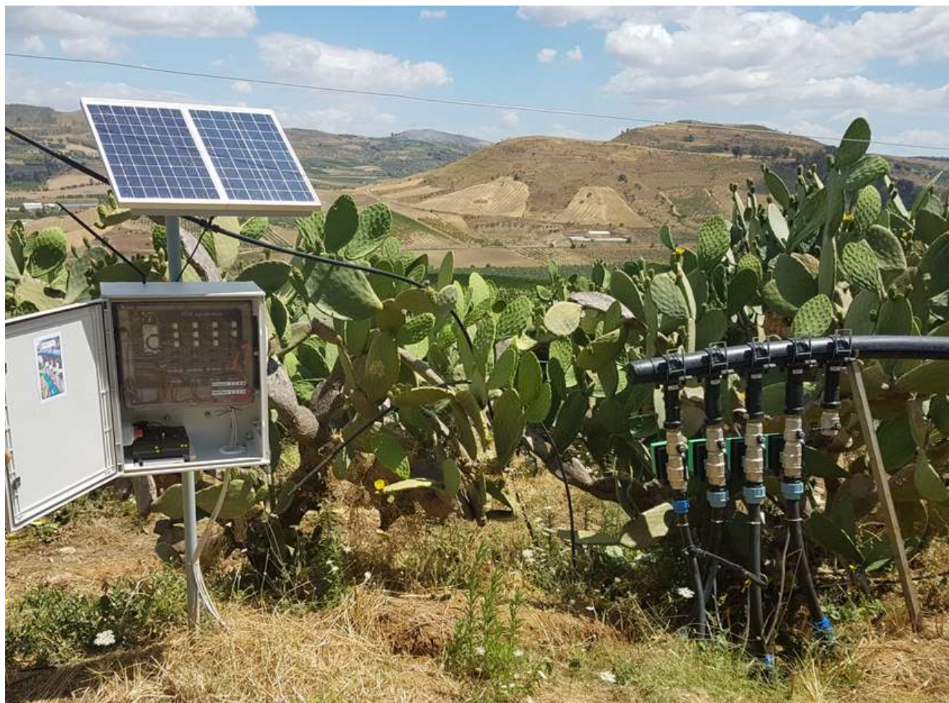
Fig.8 - Impiego delle moderne tecnologie (Arduino, pannelli solari-elettici, rete WiFi) per la gestione tramite PC/App della rete di fertirrigazione dei fichidindeti
