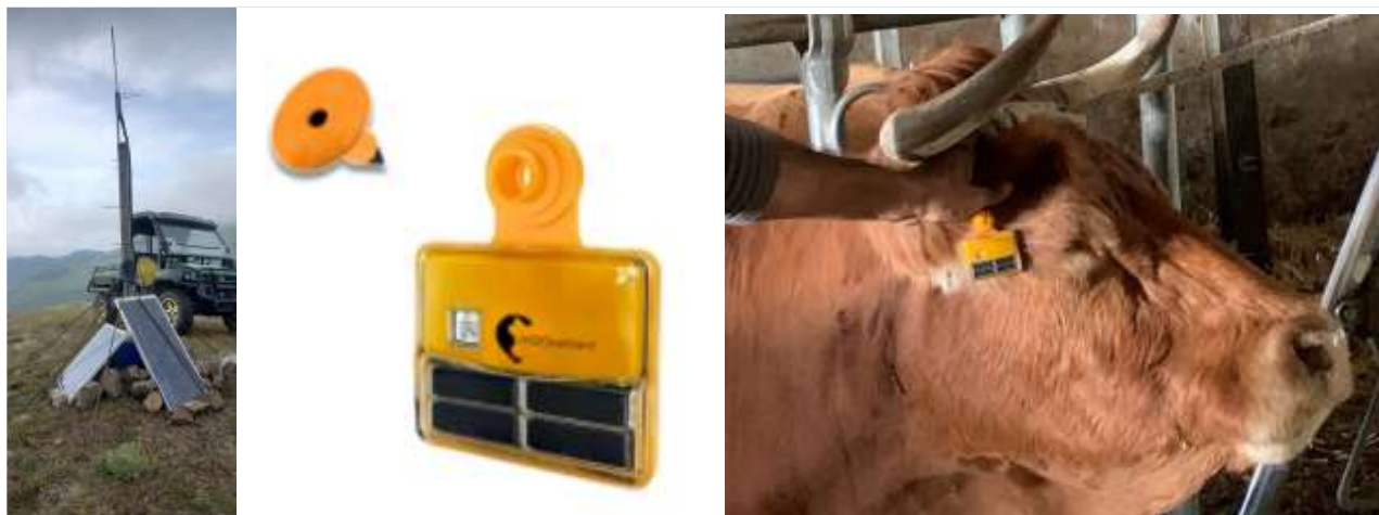
Fig. 5.3 – Sistema di geolocalizzazione degli animali al pascolo da remoto
