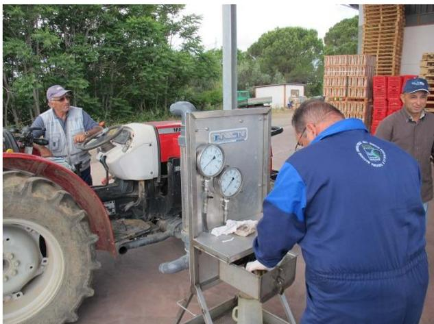
Un momento del controllo funzionale di una irroratrice: prova del manometro
