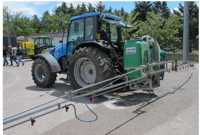
**Trattrice:** assicurarsi dell'efficienza del contagiri del motore, necessario per portare la presa di potenza al numero di giri necessario per il funzionamento ottimale della pompa (circa 540 giri/min).
