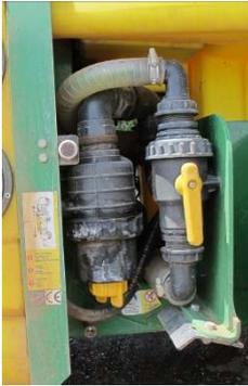
**Tubazioni e raccordi:** verificare che con la macchina in pressione le tubazioni ed i raccordi siano perfettamente a tenuta (non presentino perdite di miscela) e non
