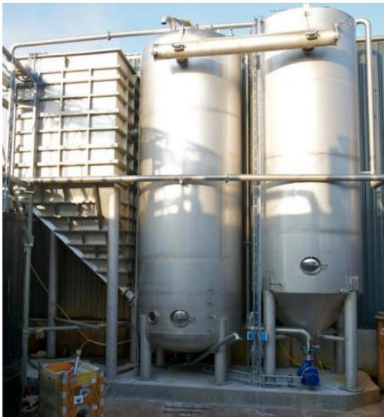
Reattore per la precipitazione della Struvite in funzione su acque di processo di uno stabilimento di lavorazione patate in Belgio.
