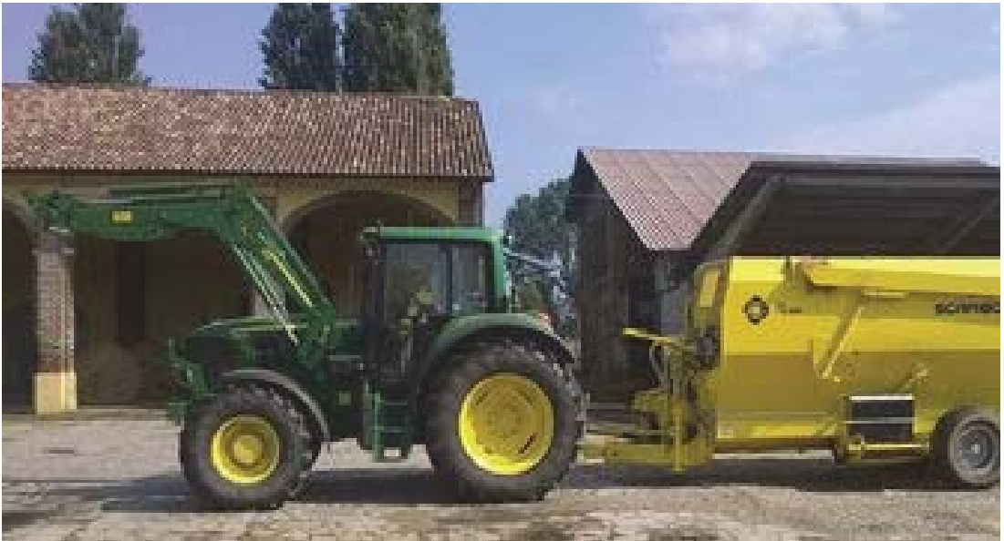
Carro miscelatore per l'alimentazione di precisione
