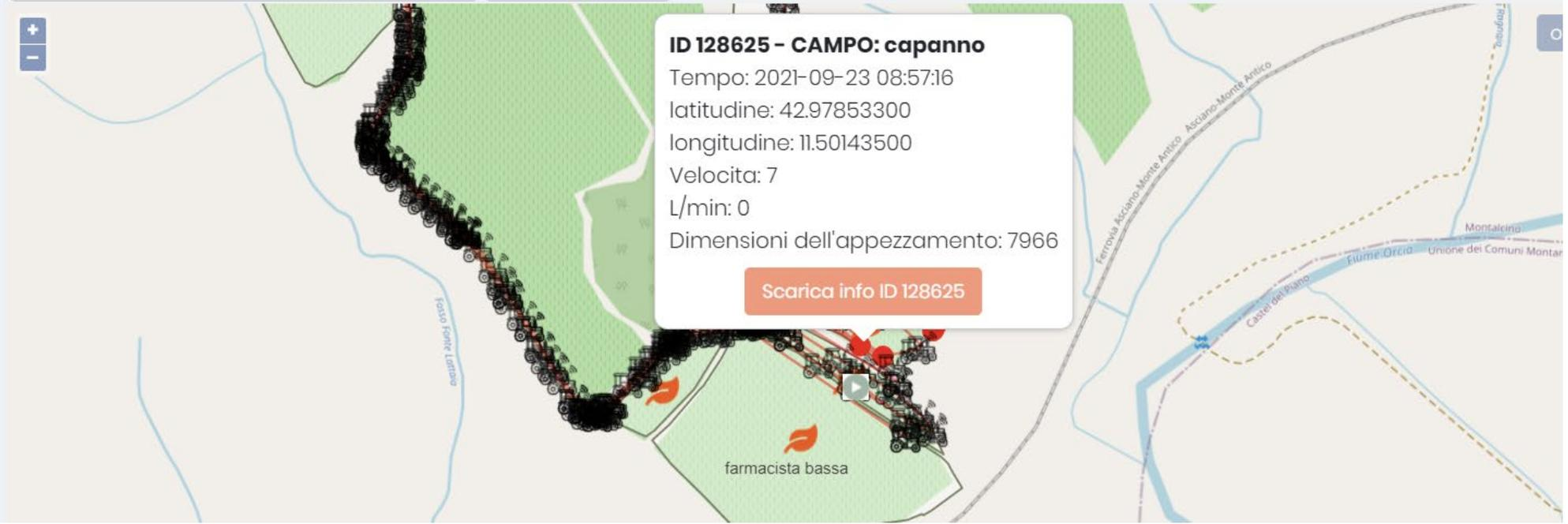
Dati di telemetria rilevati dalle centraline. In nero ogni punto del percorso del mezzo in cui le centraline hanno inviato segnali al sistema
