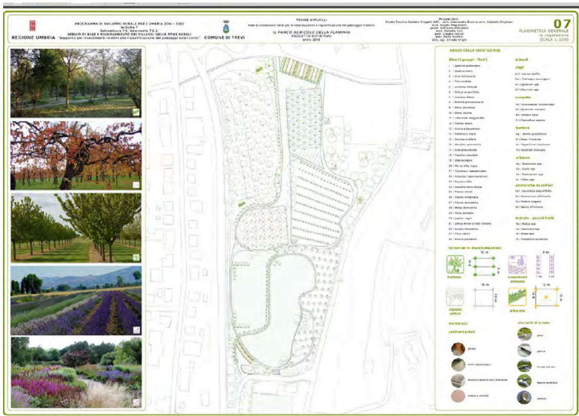
Figura 26 – Planimetria generale del Parco Agricolo della Via Flaminia con l'abaco della vegetazione
