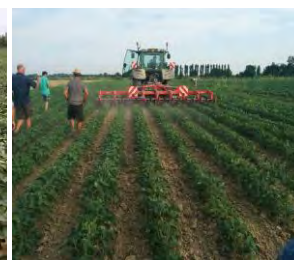
Fig. 2 Sarchiatrice a guida ottica in azione
