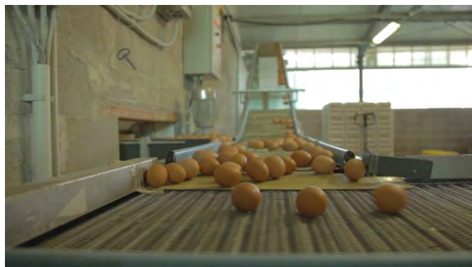
Fig. 1: Sistemi di raccolta a nastro che portano le uova nella camera di stoccaggio e confezionamento
