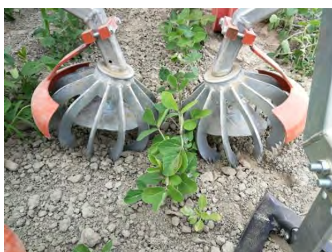
Fig. 3: Mezzi meccanici: esempio di rotosarchiatore.
