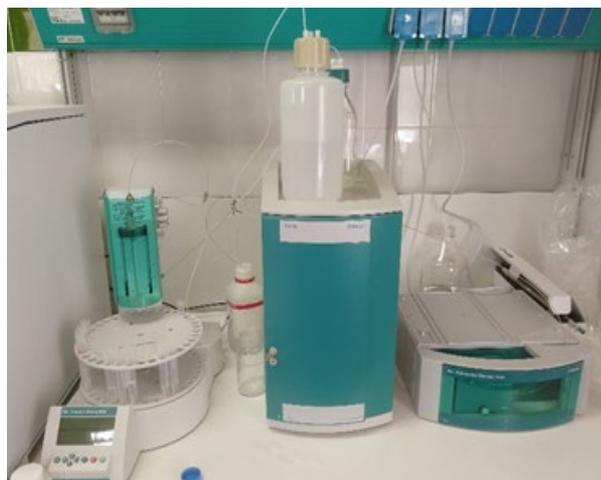
Cromatografo Ionico Metrohm ECO-IC
