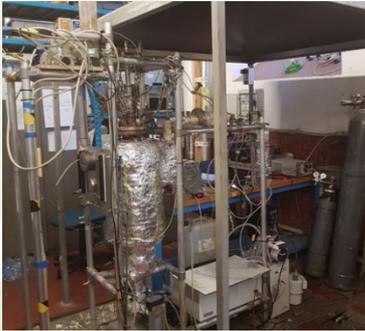
Un gassificatore a letto fluidizzato (FBG) prototipale è stato utilizzato per valutare la ripartizione tra ceneri e syngas dei metalli pesanti
