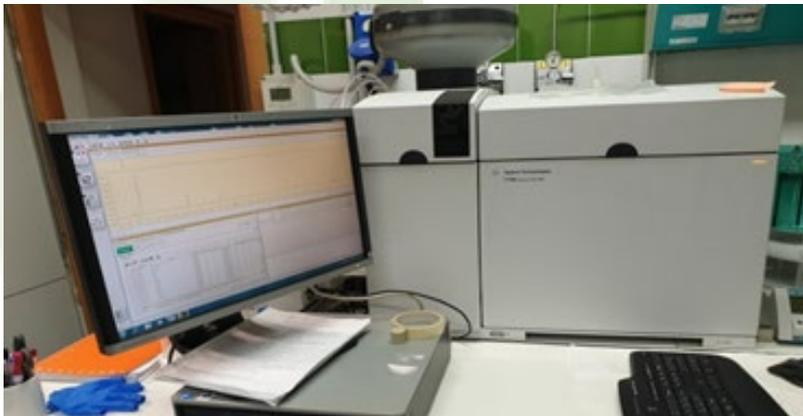
ICP-MS Agilent 7700 Determinazione contenuto di Metalli
