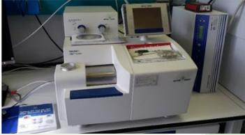
È stata utilizzata la TGA-DTA per simulare in scala di laboratorio il processo di gassificazione di biomassa PABR per valutare l'emissione di metalli pesanti.
