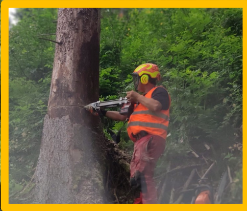
CUNEO RADIOCOMANDATO PER ABBATTIMENTI A DISTANZA
