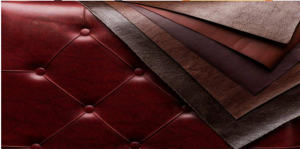
La miscela di vinacce, nel processo produttivo di Vegea, dopo essere stata spalmata e trasformata in teli, viene trattata per ottenere diverse gradazioni di peso, di elasticità, di spessore, di goffatura e di colori: in questo modo il prodotto finale si presta alla realizzazione di qualunque tipo di capo o di accessorio, dagli abiti alle scarpe, dai cappelli alle borse.
