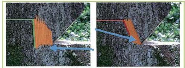
La cerniera ha il compito di sostenere l'albero e guidare la sua caduta lungo la direzione voluta, definita dalla tacca di direzione. Deve avere uno spessore di almeno  $1/10$  del diametro del tronco.
