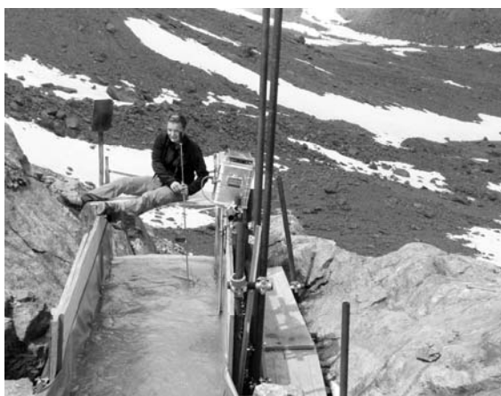
Weissbrunnferner: Wasserführungsmessung Ghiacciaio di Fontana Bianca: misura di portata
