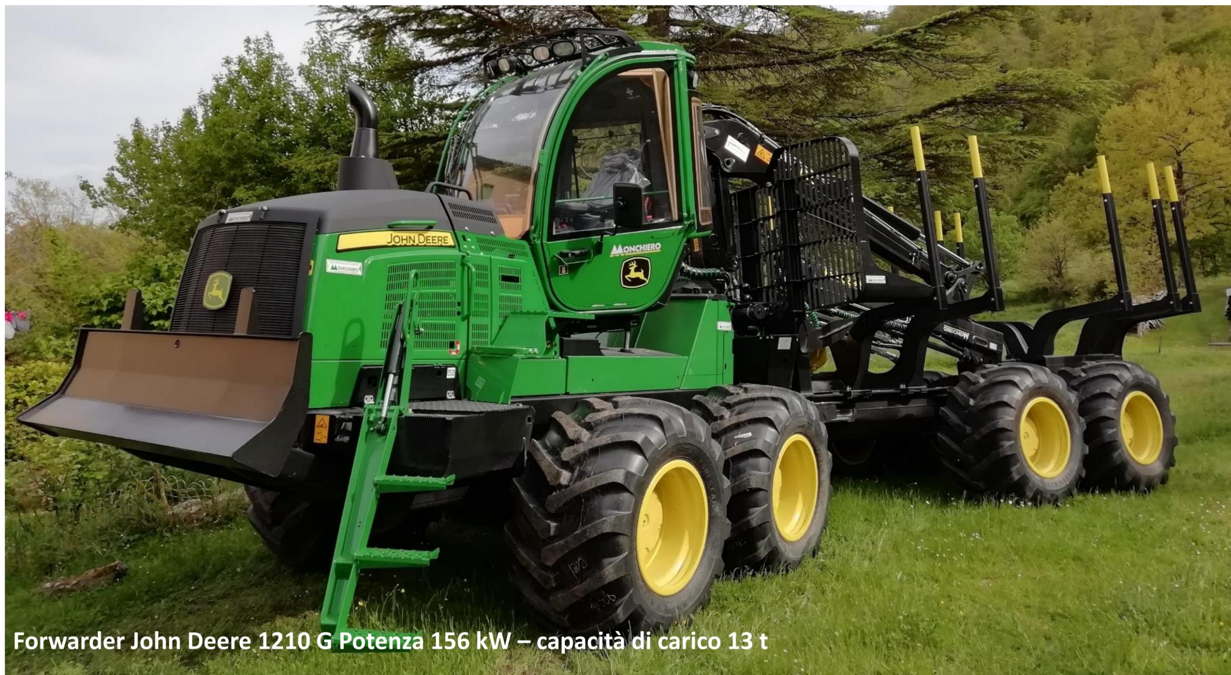
Forwarder John Deere 1210 G Potenza 156 kW – capacità di carico 13 t
