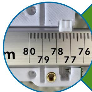
Sono state utilizzate tecniche di stampa e disegno particolari ad esempio per accomodare gli inserti in ottone filettato e gli slot per spessori in teflon utilizzati per lo scorrimento sul metallo.
