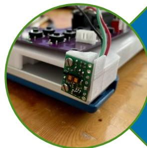
È stato scelto un sensore ToF (Time of Flight) basato su tecnologia laser perché ha un fattore di forma molto compatto e fornisce una buona precisione su un ampio spettro di misura (da 10 a 400cm circa).
