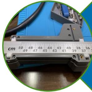
Approccio retrofit su cavalletto esistente di marca Haglof. Il modello 3D è realizzato sulla base della parte superiore a sostituzione parziale del manico.
