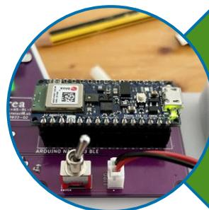
È stata scelta una Arduino Nano 33 BLE Sense perché dotata di chip Bluetooth BLE, accelerometro, microfono MEMS e molti altri sensori già a bordo.
