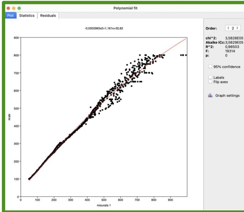
La lettura del sensore laser ToF viene interpretata attraverso un processo di curve fitting.
