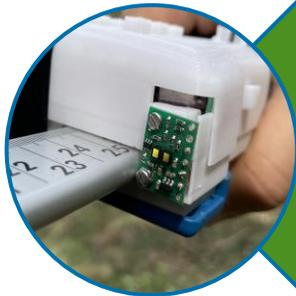
Il posizionamento sensore laser di distanza è stato scelto per ridurre al minimo le possibili interferenze fisiche dovute all'intralcio di vegetazione presente sugli alberi.
