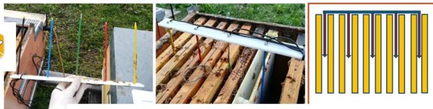
Sonda termica a "pettine" e sua collocazione
