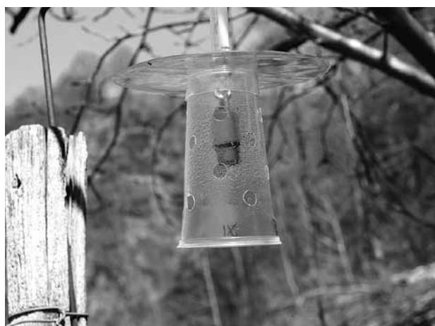
Prototipo della trappola a cairomoni per la Cacopsilla picta
