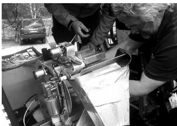
Prima del decollo dell'elicottero viene controllato il funzionamento della macchina per la distribuzione automatica delle esche vaccinali.
