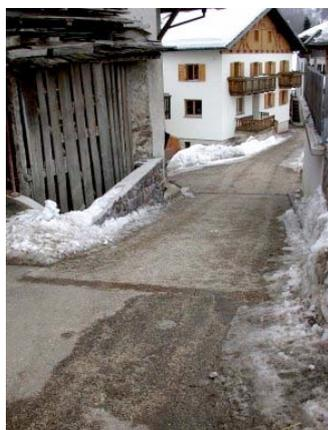
**Dopo l'intervento** la discontinuità della pavimentazione viene risolta con la pavimentazione in porfido del piazzale di accesso che qualifica la zona abitata. La realizzazione di griglie per la captazione delle acque impedisce all'acqua piovana di scorrere verso le abitazioni riducendo il disagio per la formazione di fango e per possibili ristagni idrici.
