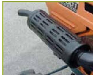
**Superfici calde:** Le parti della macchina che, in fase di lavoro, raggiungono temperature elevate devono essere protette con griglie o reti metalliche posizionate ad adeguata distanza dalla fonte di calore in modo da evitare che si surriscaldino.
