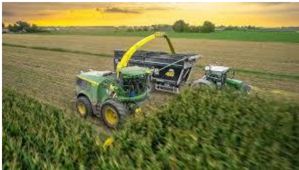
Falcitrinciacaricatrice con rimorchi al seguito per efficientare logistica conferimenti.
