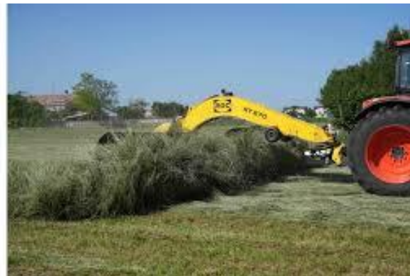
Linea essiccato prima condizionatrice commerciale sviluppata con il contributo del CREA
