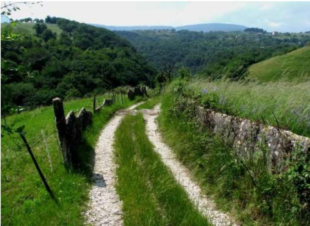
*Muri a secco realizzati in laste verticali alle altitudini maggiori: la conformazione geologica delle quote più alte fornisce pietre in un certo senso già pronte all'uso, separate in strati facilmente estraibili e utilizzati per svariati scopi, tra cui la realizzazione di recinzioni e le sistemazioni idraulico agrarie. Nella foto in alto il dettaglio di due laste di pietra di Prun poste al limite di un vigneto.*
