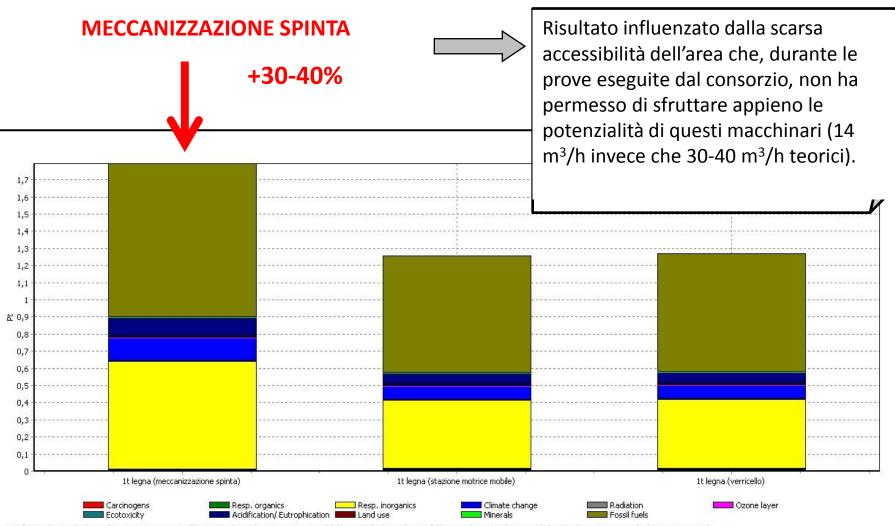
Confronto di 1 ton '1t legna (meccanizzazione spinta)', 1 ton '1t legna (stazione motrice mobile)' e 1 ton '1t legna (verricello)'; Metodo: Eco-indicator 99 (H) V2.06 / Europe EI 99 H/A / punteggio singolo
