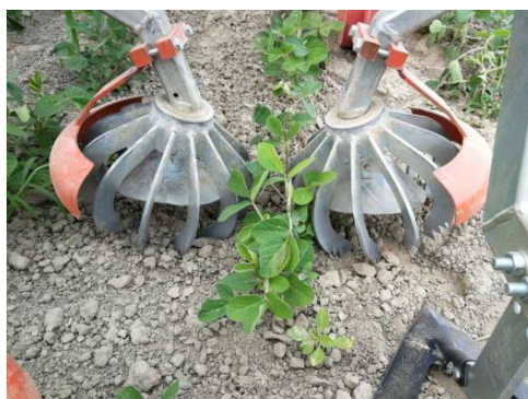
Fig. 3: Mezzi meccanici: esempio di rotosarchiatore.
