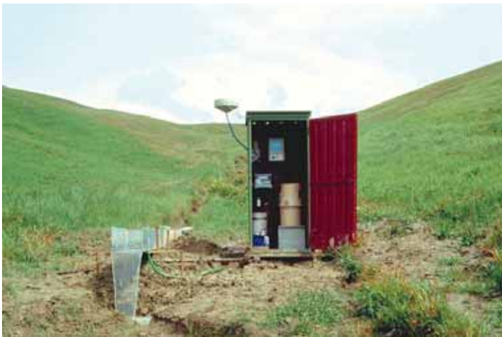
Figura 5.11. Unità idrologica ISCO per la misura del deflusso e dell'erosione bacinale.
