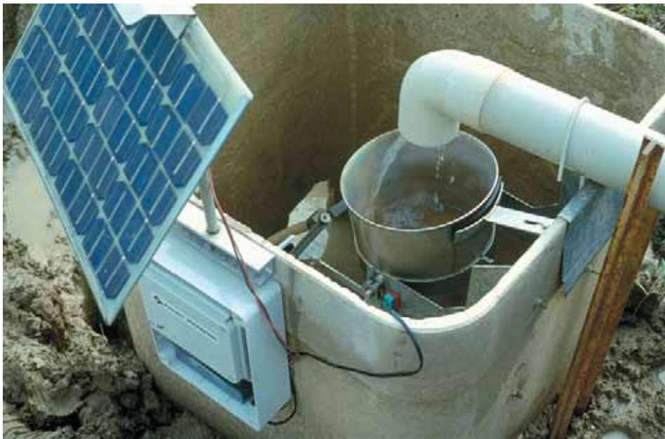
Figura 5.10. Unità di misura elettronica FAGNA-TYPE parcellare.
