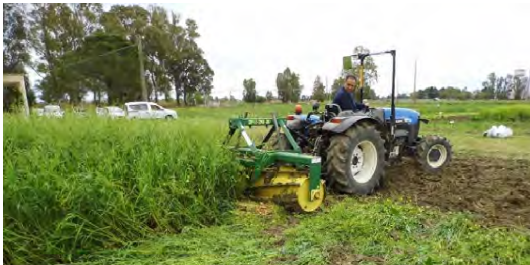
Fig. 3 - Roller crimper utilizzato per l'allettamento di colture di copertura
