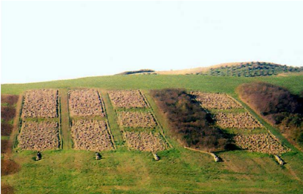
Figura 12. Impianto parcellare a Vicarello (Volterra) per la misura dei deflussi e dell'erosione; si notino le strisce inerbite.
