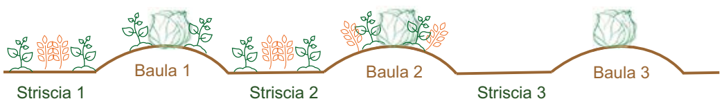
Fig. 2 - Presentazione schematica della sistemazione idraulica per baulatura nel dispositivo MITIORG: sulle strisce e baule 1 e 2 sono presenti colture di copertura allettate o sovesciate, mentre la striscia e baula 3 rappresentano il controllo senza colture di copertura
