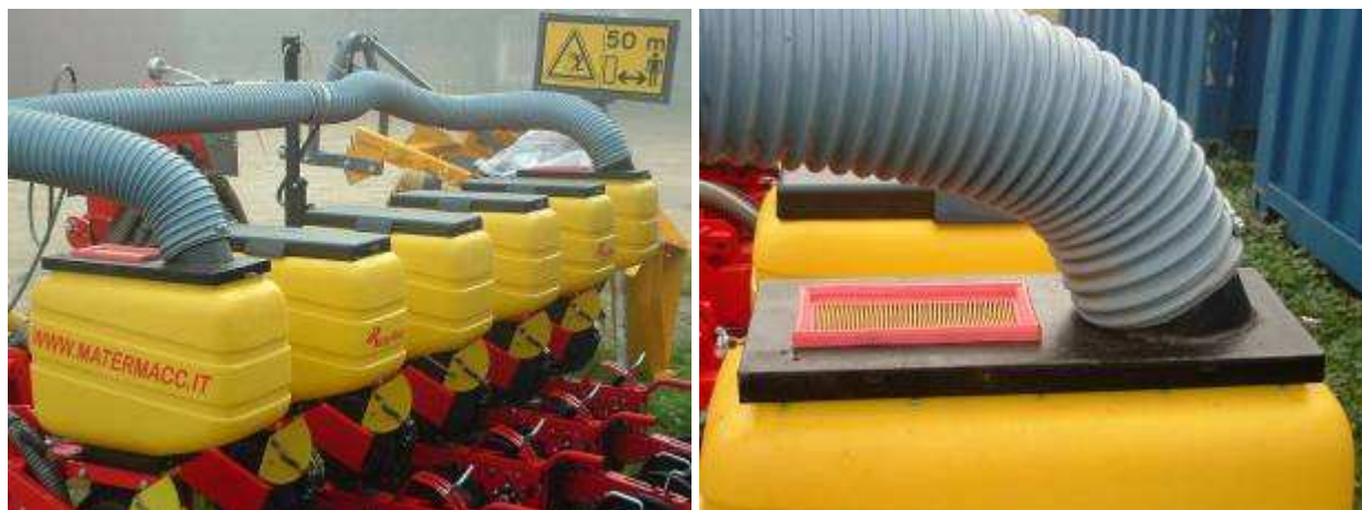
Figura 10 – Prototipo 1 del CRA-ING applicato alla seminatrice Maternacc impiegata nelle prove APENET 2009. Un prototipo analogo è stato applicato alla seminatrice Gaspardo Magica, adattandolo al tipo di deflettori montato su di essa. Il prototipo in figura è stato concepito come possibile soluzione applicabile a seminatrici usate con interventi contenuti.
