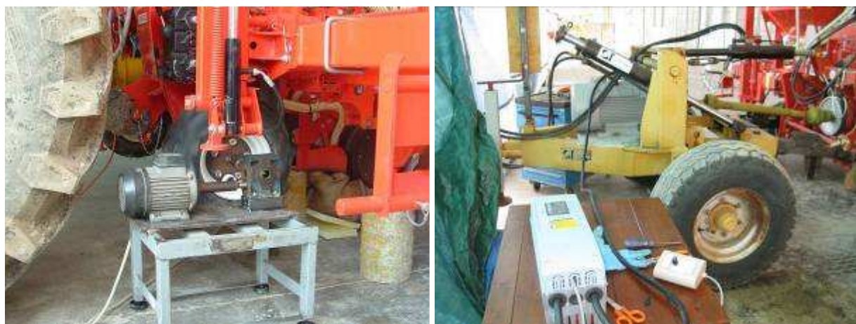
Figura 8 – Sinistra: motore elettrico e inverter per azionare la ruota motrice; Destra: motore elettrico ed inverter per azionare il depressore.
