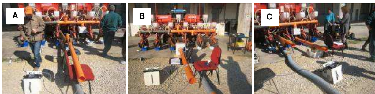
Figura 12 – A) Campionamento aria in uscita senza filtraggio; B) campionamento dell’aria che passa direttamente dentro il filtro; C) campionamento dell’aria che esce con la modifica normalmente applicata.
