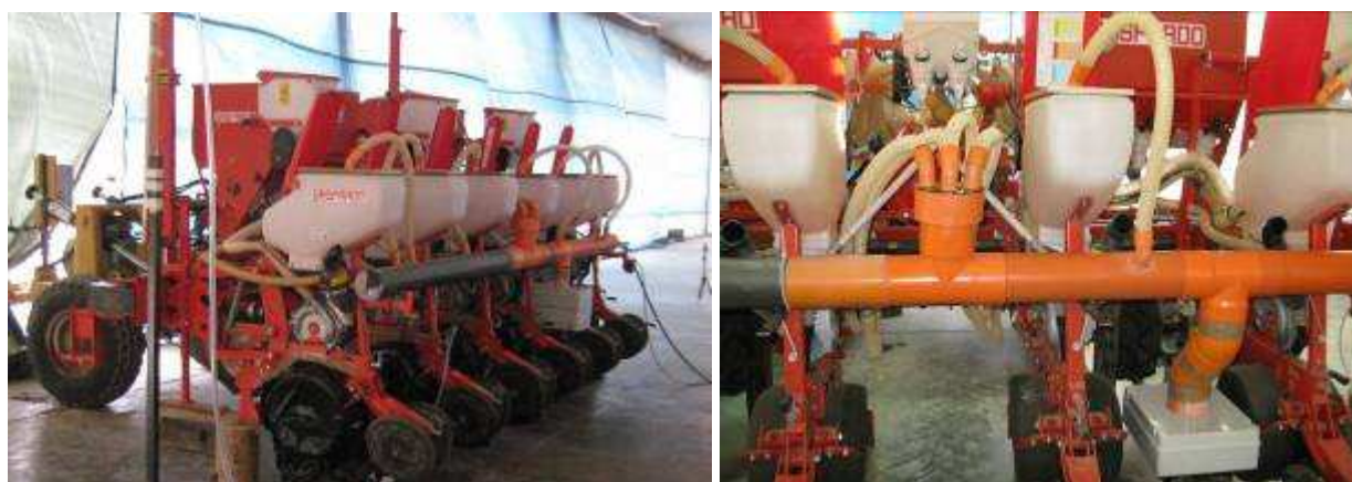
Figura 11 – Prototipo 2 del CRA-ING applicato alla seminatrice Gaspardo Magica descritta al punto 5.3.4. Il filtro qui impiegato è un filtro per uso automobilistico (filtro antipolline a carboni attivi per abitacolo). Questa soluzione è idonea ad essere applicata su seminatrici nuove da parte del costruttore
