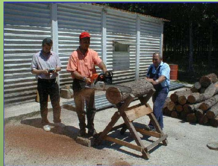
**Misurazione delle vibrazioni sul maniglione anteriore durante la fase di taglio - ERGOLAB UNITUS**
