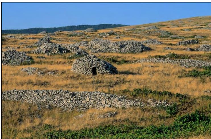
*Figura: Thòlos, tipologia di costruzioni spontanee frequentissime sulle balze ed i pascoli della montagna: le capanne a tholos, dette in dialetto "pajare", venivano innalzate con un ingegnoso sistema di costruzione a secco, senza l'uso di cementi.
